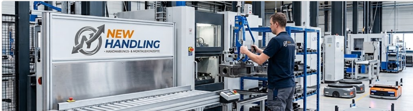
NewHandling Kolibri I-Go Manipulator an einer halbautomatischen Montagelinie mit integrierter Fördereinrichtung
